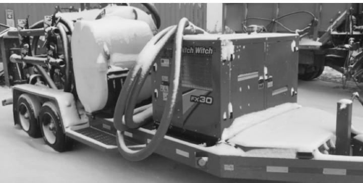
SYSTÈME D'ASPIRATION UTILISÉ POUR RÉCUPÉRER LES EAUX ET LES MATIÈRES SOLIDES CONTAMINÉES.
