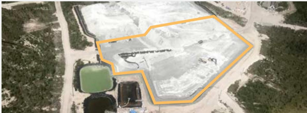
En 2018, Minière Osisko a construit cette expansion de la halde de roches stériles imperméabilisée.
