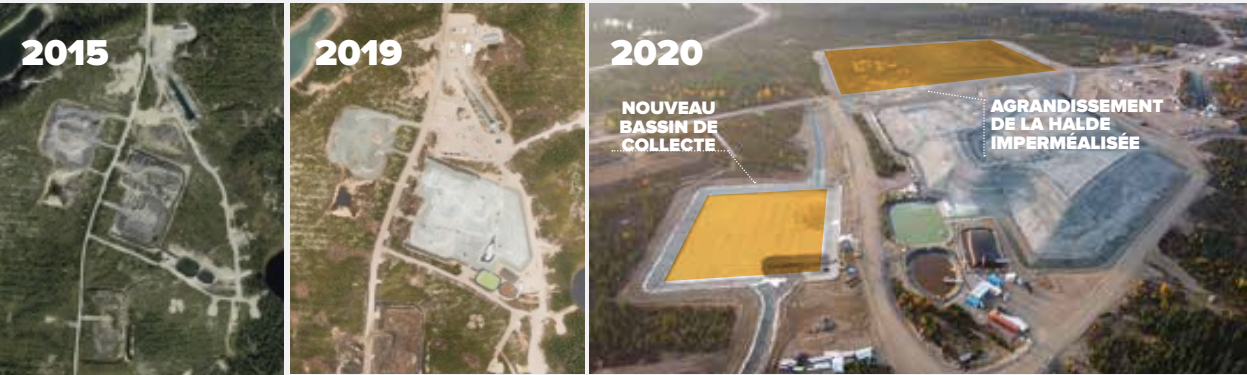
L'évolution de la halde à stériles imperméabilisée et du système de gestion des eaux (2015,2019, 2020).
